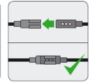
Localizar los dos conectores de batería y conectarlos de forma segura y firma
