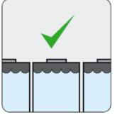
Rellenar la batería según requerido por el fabricante
