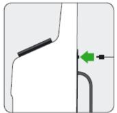
Conectar el cargador de 12V a la toma trasera del carro
