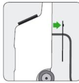
Extraer los tornillos y sacar la tapa trasera del HydroFill
