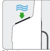
Rellenar el tanque con agua desionizada
