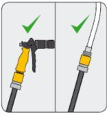
Conectar la manguera del carro a una pistola de agua o sistema de relleno de baja presión
